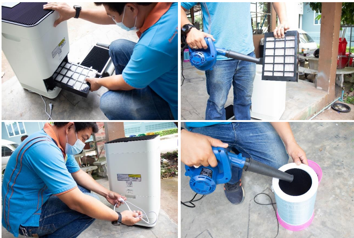
ภาพถ่ายการถอดแผ่นกรองอากาศเพื่อทำความสะอาดเครื่องฟอกอากาศ
